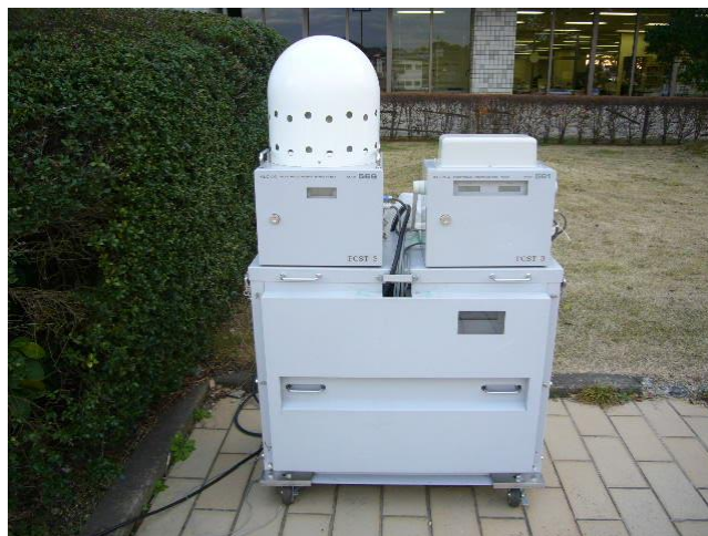
茨城県において北茨城市役所に設置している可搬型モニタリングポスト
